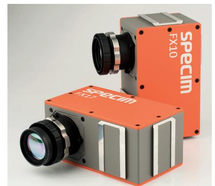
Bild 3. Bei den kompakten Hyperspektralkameras FX10 und FX17 des finnischen Herstellers Specim ist der erforderliche Spektrograph direkt in das Kameragehäuse integriert. (© Stemmer Imaging)
